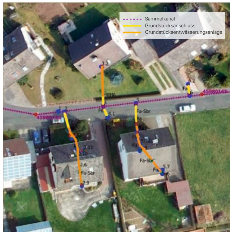
Abb. 13: Grundstücksentwässerungsanlagen, -anschlüsse und Sammelkanäle bilden eine Einheit.
