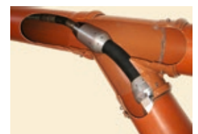
Abb. 32, 33, 34: Eine mechanische Vorrichtung ermöglicht das Abbiegen der Kamera in einen Abzweig (Beispiel „Lindauer Schere“).
